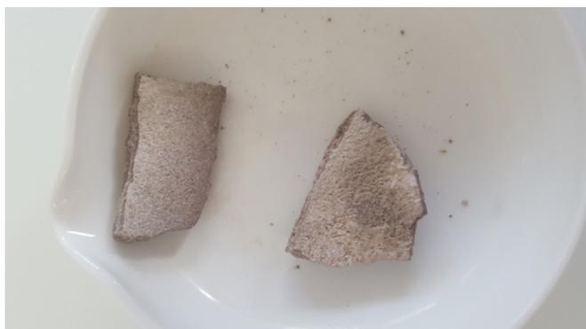
**Imagen 2. Incrustación de carbonato cálcico encontrada en un condensador evaporativo**
