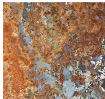
**Imagen 1. Corrosión química encontrada en una torre de refrigeración**
